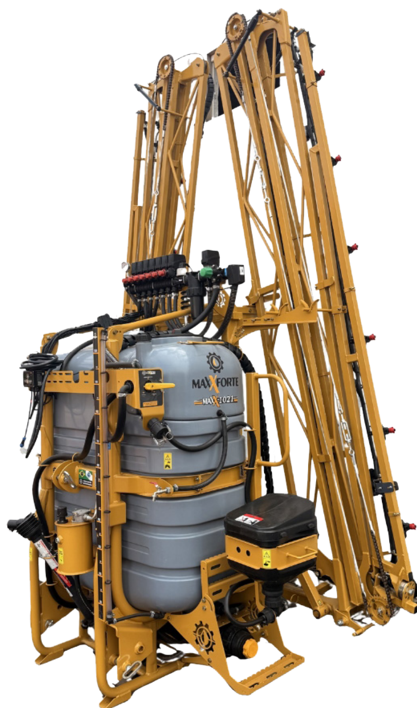
Pulverizador Maxxforte 600 Litros 16M Com. Manual Incorporador Lateral Cód. 154365
